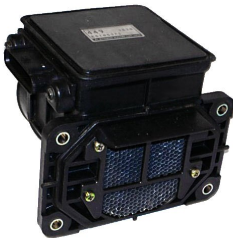
Датчик расхода воздуха производства MITSUBISHI, работающий на принципе подсчета вихрей Кармана.
