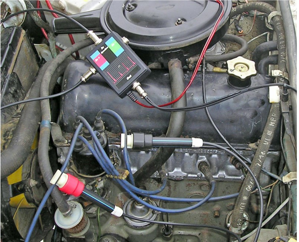
Классическое зажигание. Подключение высоковольтных датчиков.
