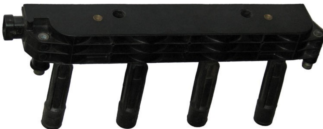
Модуль зажигания, состоящий из четырёх стержневых индивидуальных катушек зажигания.
