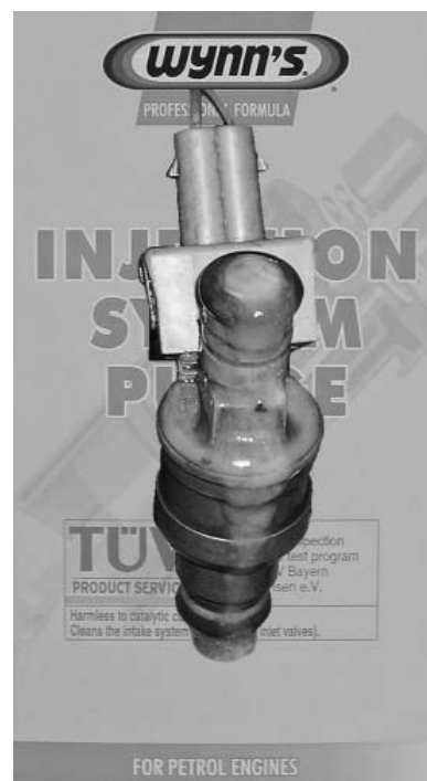
Рис. 3. Внешнее проявление движения клапана форсунки под воздействием специальных управляющих импульсов
