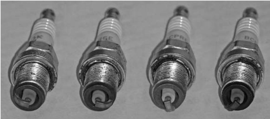
Рис. 1. Разный цвет отложений на изоляторах свечей зажигания со стороны камеры сгорания может служить дополнительным признаком неравномерности впрыска топлива
