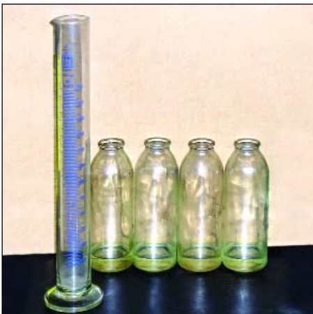
Рис. 12. Измерение количества пролитого каждой форсункой топлива производится с помощью мерной мензурки.
