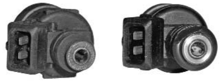
Рис. 2. Внешний вид входных штуцеров бензиновых форсунок. Поверхность входного штуцера форсунки, показанной слева, покрыта коррозией, что является признаком коррозии её внутренних элементов. Топливный уплотнитель на штуцере форсунки показанной справа поврежден.
