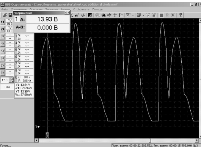
Рис. 7. Короткое замыкание диода возбуждения (замыкание диода, соединённого с выводом "D+" генератора). На схеме показан как "VD1 d+...VD3 d+"
