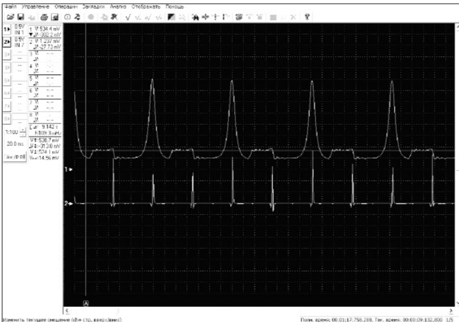
Рис. 4. Осциллограмма давления в цилиндре
