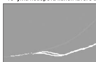
Рис. 6. Распредвал опаздывает относительно коленвала на 1 зуб (на ~15° угла поворота коленчатого вала двигателя)
