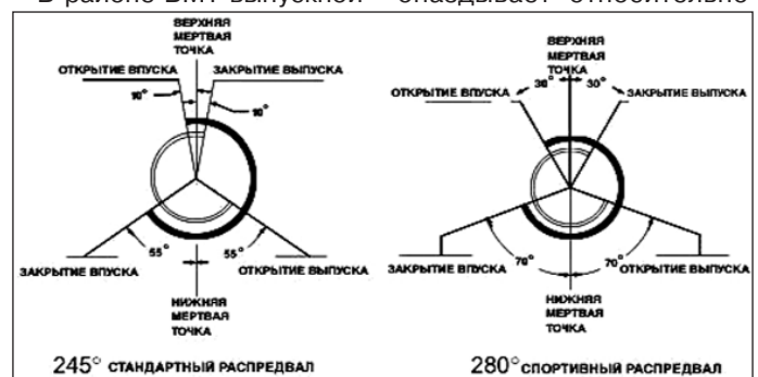
Рис. 5. Фазы газораспределения "стандартного" и "спортивного" распредвалов
