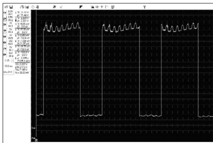
Рис. 2. Осциллограмма тестирования датчика Холла
