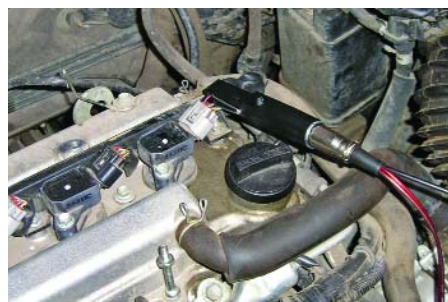
Рис. 3. Подключение токовых клещей СТІ к индивидуальной катушке зажигания
