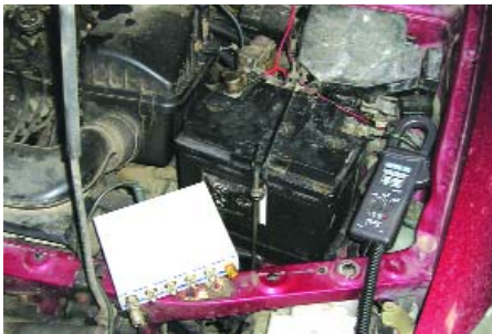
Рис. 1. Подключение токовых клещей APPA 32 для измерения тока стартера
