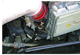
Рис. 6. Подключение токовых клещей СТ1 к цепи управления насосной секцией дизельного двигателя грузового автомобиля Renault Magnum 480 ET
