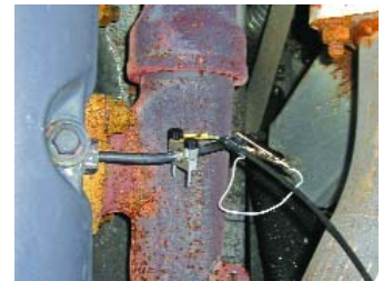
Рис. 7. Подключение пьезоэлектрического датчика ПД-6 к топливopоводу высокого давления насосной секцией дизельного двигателя грузового автомобиля Renault Magnum 480 ET
