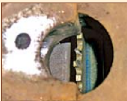
Рисунок 23. Изогнутые зубья задающего зубчатого венца
