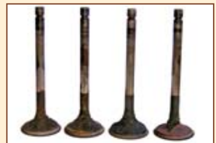
Рисунок 5. Впускные клапана со значительным нагаром на тарелках.
