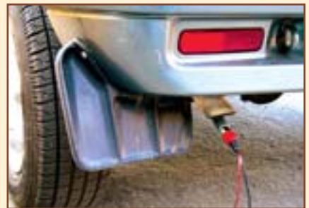
Рисунок 10. Подсоединение датчика Dх к выхлопной трубе автомобиля Chevrolet Niva 1.7i
