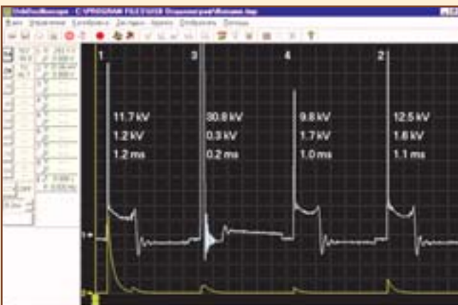
Рисунок 16. Высоковольтный провод цилиндра №3 оборван.
