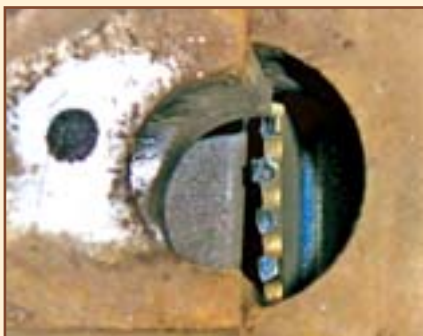
Рисунок 22. Смятые зубья задающего зубчатого венца
