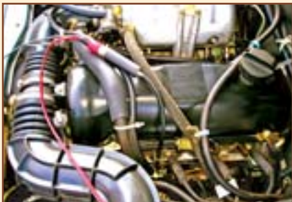
Рисунок 7 . Подсоединение датчика Dх к колдунцу масляного щупа автомобиля Chevrolet Niva 1.7i
