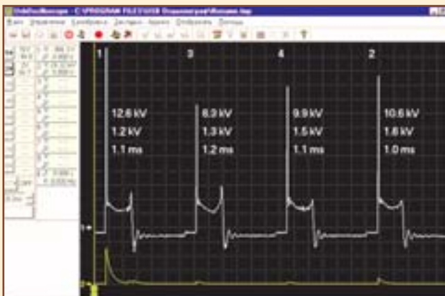
Рисунок 14. Режим "Парад цилиндров" с отображением параметров высоковольтных импульсов отдельно для каждого цилиндра.
