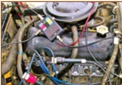
Рисунок 13. Подключение высоковольтных датчиков к классической системе зажигания.
