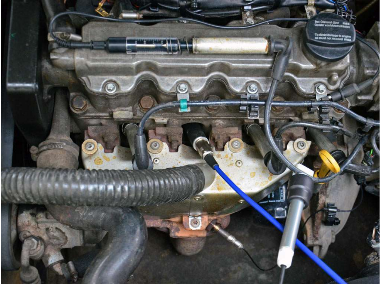
На место свечи зажигания установлен датчик давления в цилиндре Rx.
