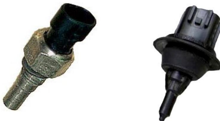
*Внешний вид датчика температуры охлаждающей жидкости (слева) и датчика температуры воздуха во впускном тракте (справа).*
