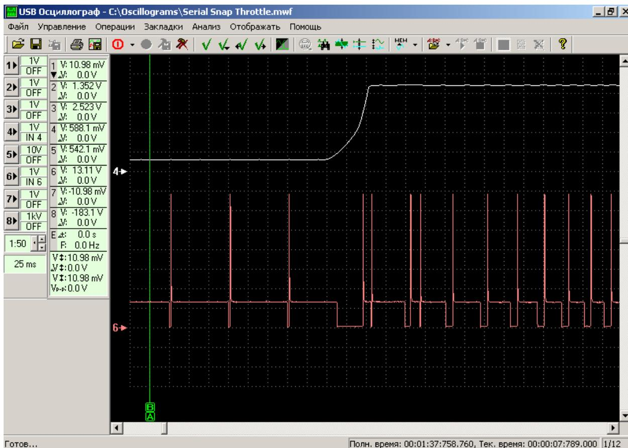
Осциллограммы напряжения сигнала управления форсункой и сигнала от датчика положения дроссельной заслонки системы фазированного впрыска топлива в момент резкой перегазовки.
