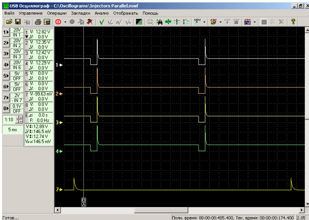
Осциллограммы напряжения сигналов системы управления 4-х цилиндрового 4-х тактного двигателя, осуществляющей параллельный впрыск топлива, демонстрирующие схему впрыска топлива данной системы.
