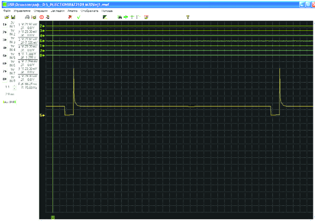
Рис. 3. Осциллограмма импульса управления форсункой, снятая при помощи USB-Autoscope I (на примере автомобиля ВАЗ-2109 с контроллером MP 7.0H)
