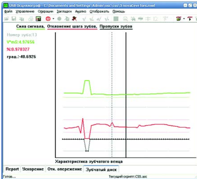
Рис. 3. Данный пример снят с инжекторного двигателя автомобиля ВАЗ 2107
