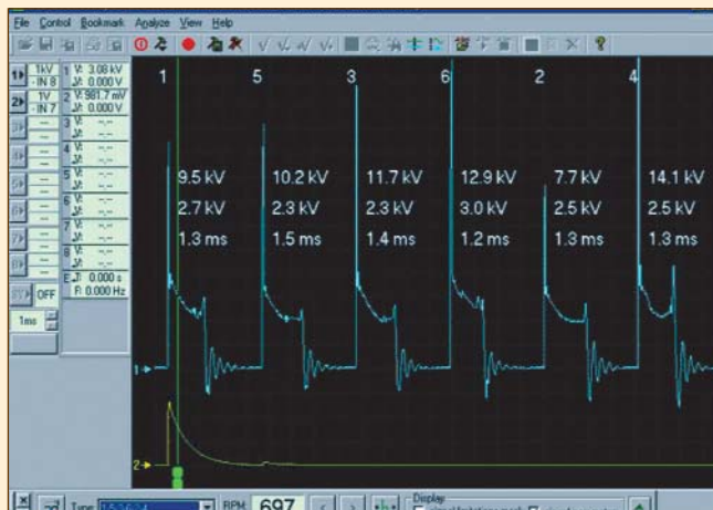
Рисунок 14. Пример расчёта и отображения осциллографом частоты вращения двигателя в Оборотах за минуту в автоматическом режиме на основании сигналов системы зажигания.
