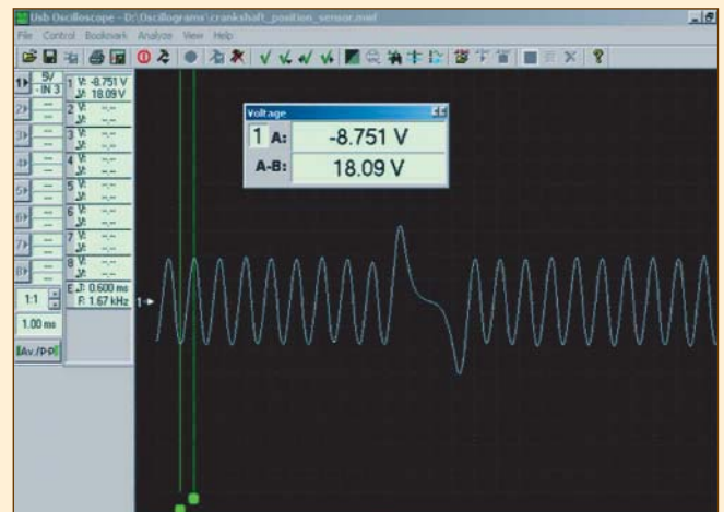
Рисунок 11. Осциллограмма выходного напряжения датчика положения/частоты вращения коленчатого вала установленного напротив зубчатого колеса с двумя недостающими зубами.
