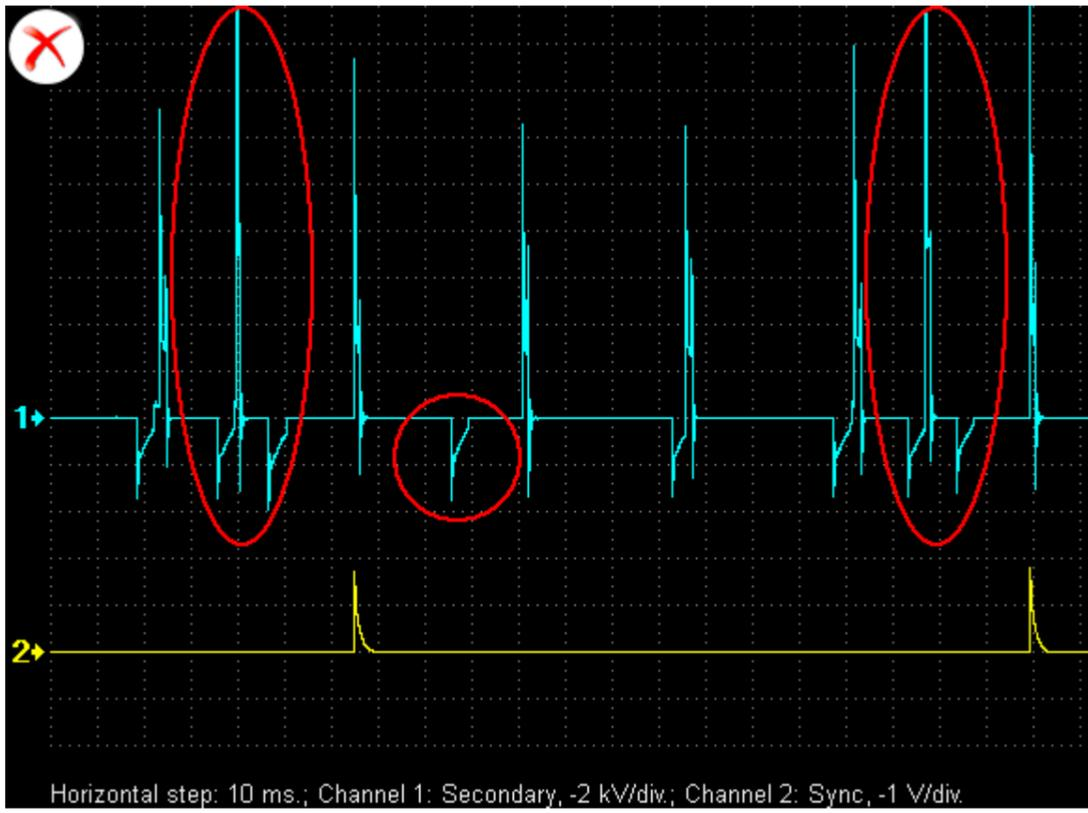
*Пример генерации системой зажигания «лишней искры» и неудачного выбора момента начала заряда катушки из-за нарушения сигнала от датчика распредвала.*
