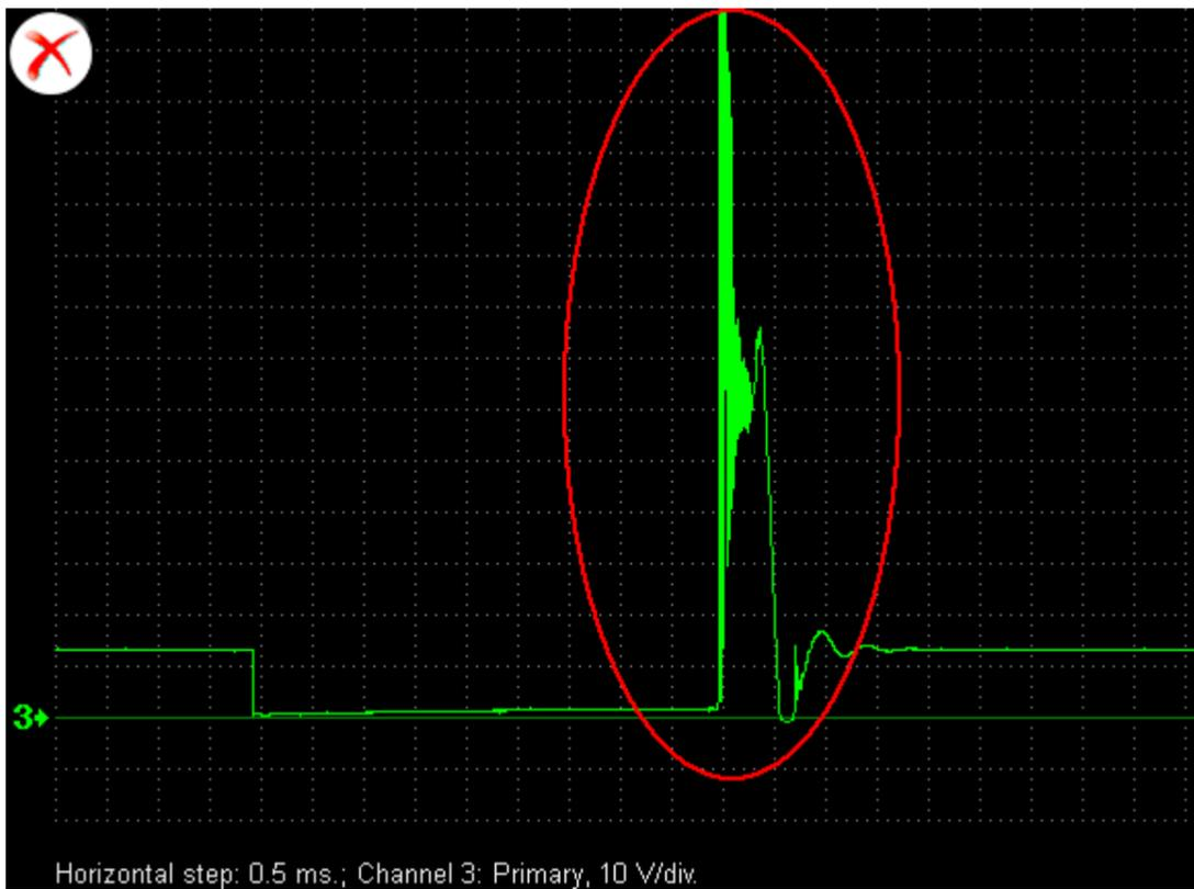
*Осциллограмма напряжения в первичной цепи неисправной системы зажигания. Большое сопротивление высоковольтных проводов.*
