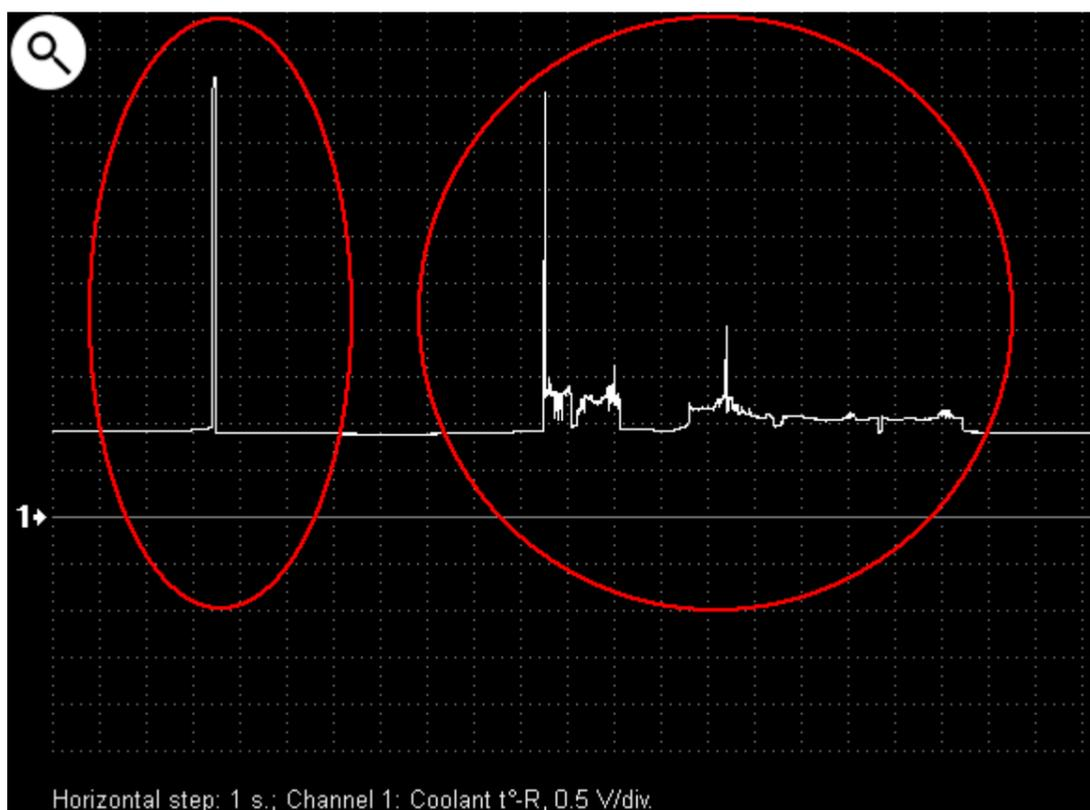
*Осциллограмма напряжения выходного сигнала неисправного датчика температуры охлаждающей жидкости двигателя. В процессе нагрева в цепи датчика возникают обрывы.*
