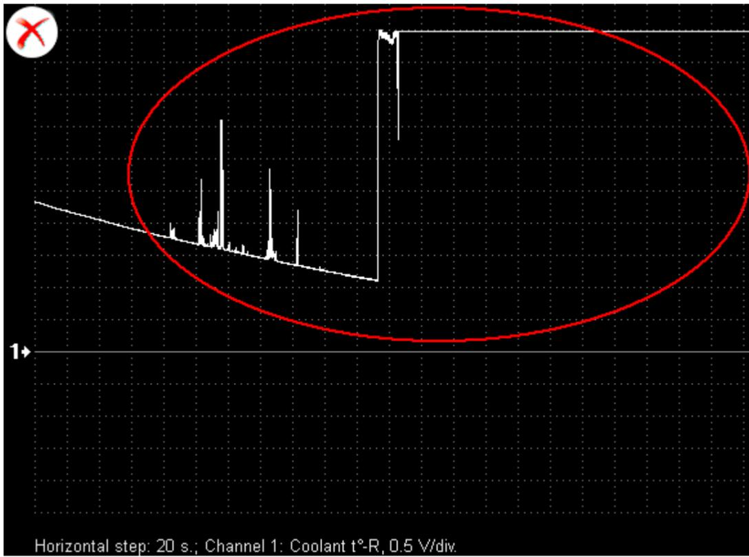
*Осциллограмма напряжения выходного сигнала неисправного датчика температуры охлаждающей жидкости двигателя.*
